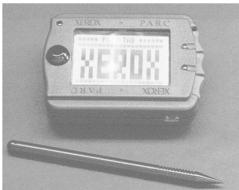
Abbildung 1: Prototyp eines elektronischen Zettels. Er kommt mit wenigen Bedientasten aus. Eingaben erfolgen mit einem Stift auf der drucksensorischen Anzeige.
